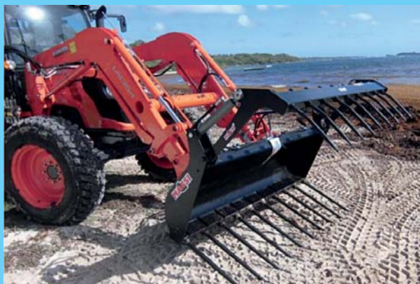
Figure 6 : Exemple de techniques pouvant limiter le prélèvement de sables associé à la collecte des sargasses. À gauche, tractopelle équipé d'un godet griffet et à droite cribleuse (source : Préfecture de Guadeloupe)
